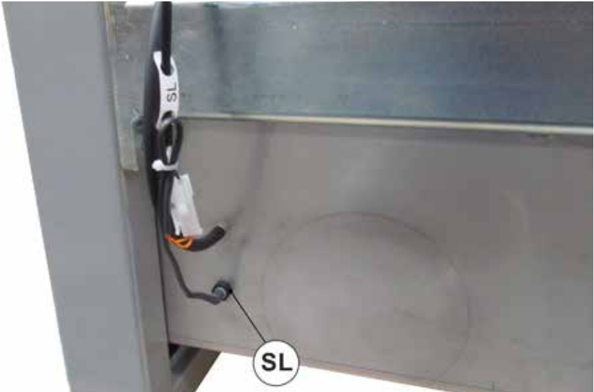
Положение датчика уровня конденсата
